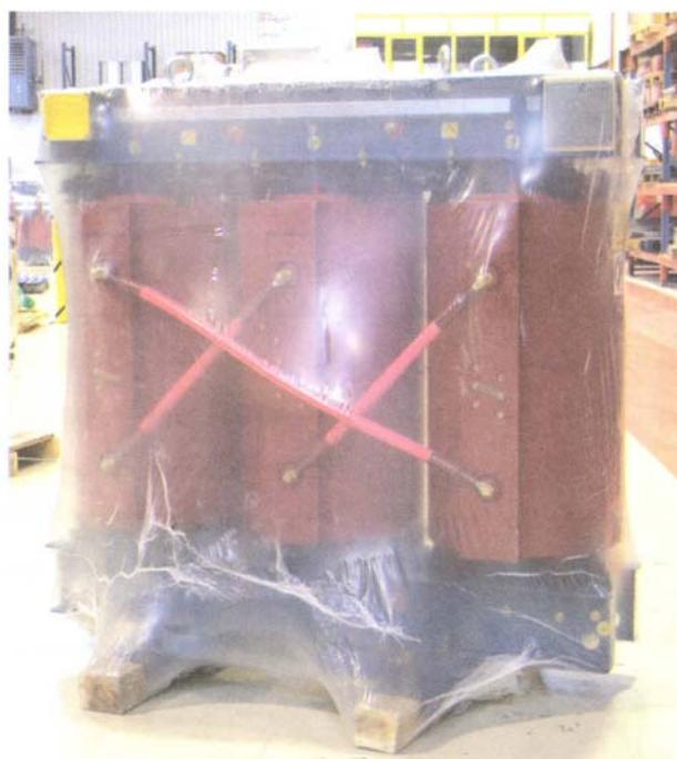
شکل ۱۵- بسته بندی کامل ترانسفورماتور
