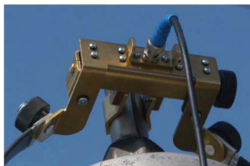
شکل (۲). نحوه اتصال کابلهای اندازه گیری به پوشینگها
